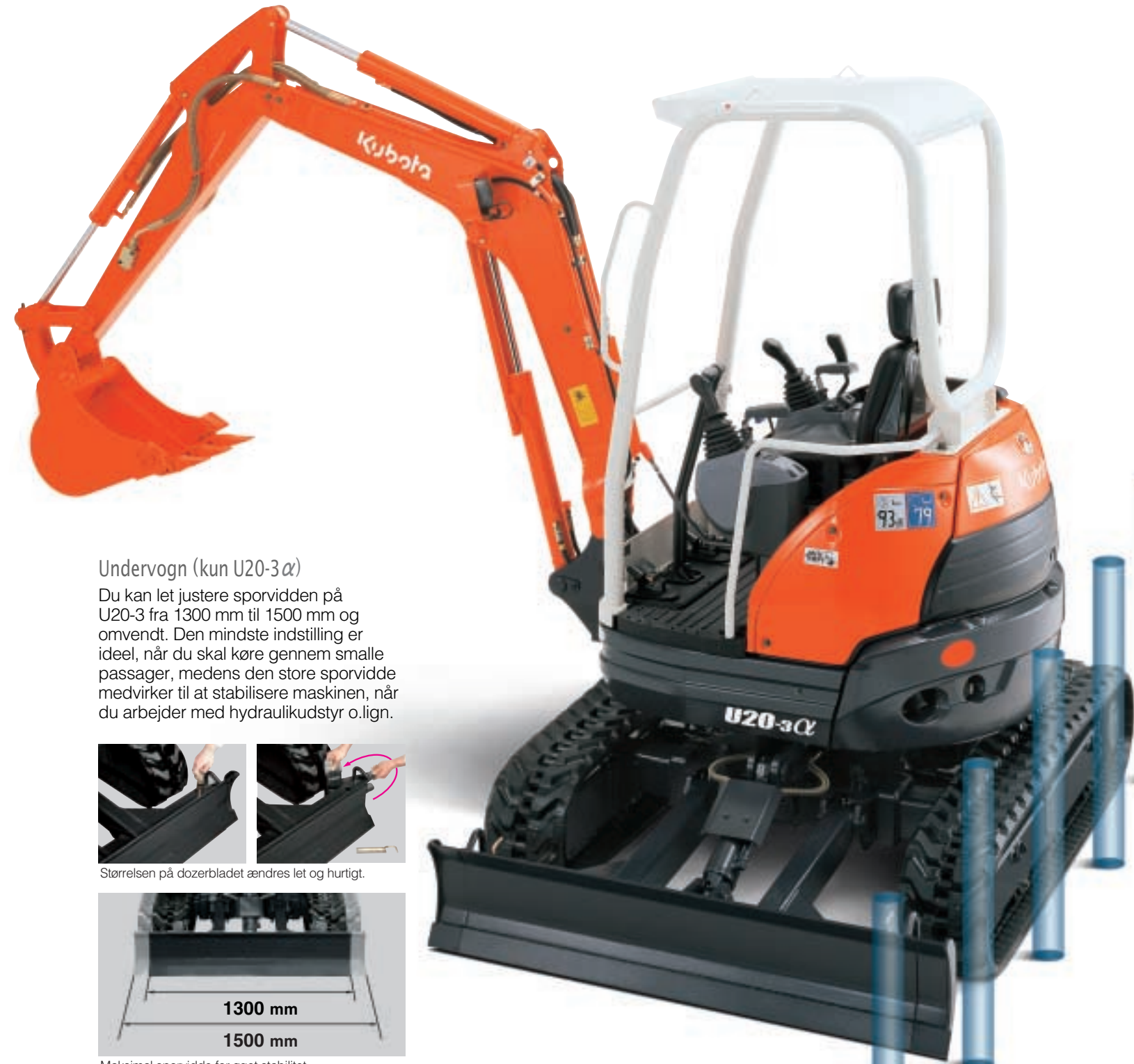
Maksimal sporvidde for øget stabilitet. Minimal sporvidde når pladsen er trang.
