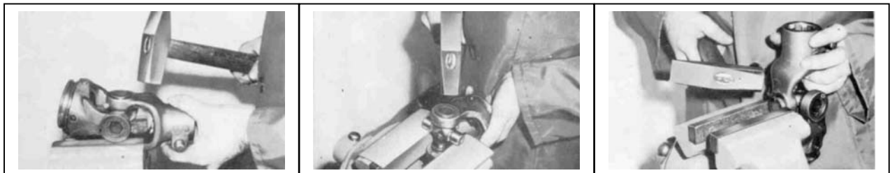
Gaffel legges på og lagerbøssing drives opp med lette slag, som vist lenger opp
