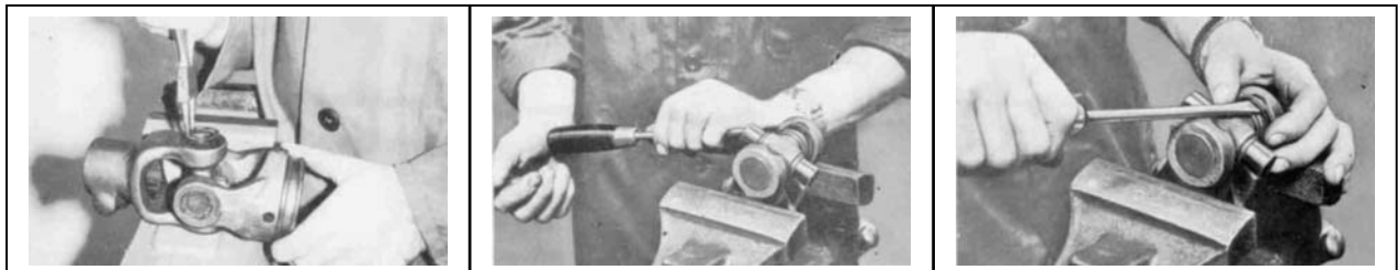
Ved ytre sikring løsnes sikringsring med monteringsstang.
