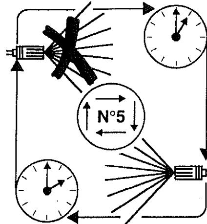
**Advarsel:** Når maskinen er NY, behøves det en kort innkjøring av motor/pumpegruppen. Innkjøring betyr at maskinen blir satt i funksjon i ikke lengre enn 1 time og lar den stå 1 time til den blir avkjølt. Denne operasjonen må gjentas 4 eller 5 ganger.
