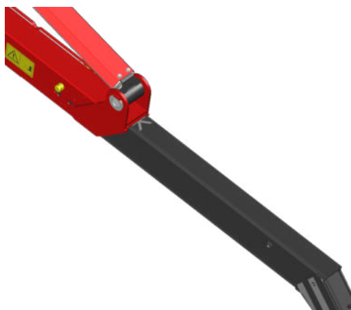
Figur 4.6 Frigjøre uttrekkbar støttebenseksjon
