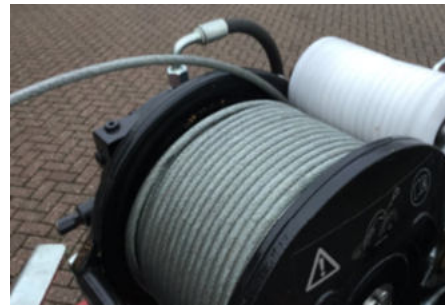
Figur 4.13 Kabel stram på trommelen
