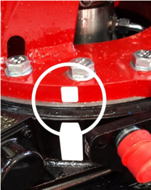
Figur 7.2 Midtposisjon av kranøylen
